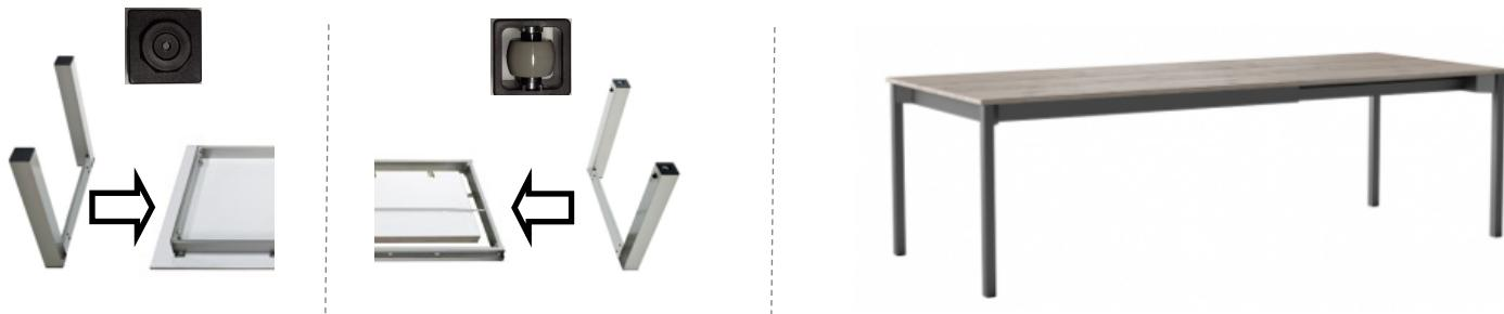
NI: 1) poten maximaal uitschuiven 2-3-4-5) beide verlengstukken gelijktijdig naar boven kantelen, dan pas openvouwen 6) verlengstuk maximaal over poten schuiven 7) poten dichtschuiven.
